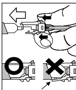
装着後は左下の状態となります。クリップの爪が上がった状態（右下）は押し込みが不完全です。
