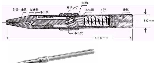
・材質 ステンレス鋼SUS304 SUS303
